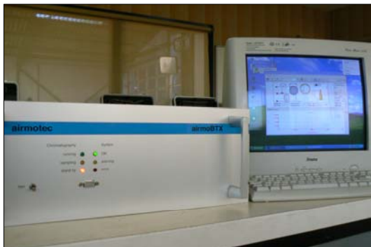
Photo 2 : analyseur automatique de benzène
