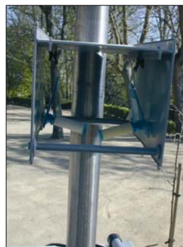
Photo 1 : tubes à diffusion passive installés dans leur boîte de protection
