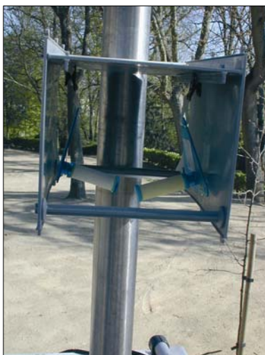
Photo 3 : tubes à diffusion passive dans leur boîte de protection
