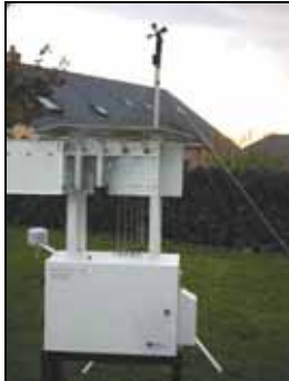
Nouveau système de collecte pour les prélèvements d'acide chlorhydrique et de métaux
