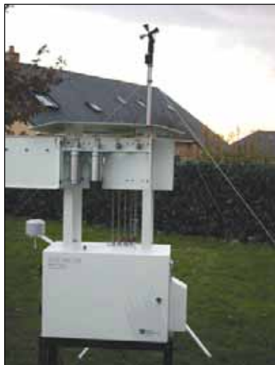
Photo 4 : Vue d'un système de prélèvement par filtre
