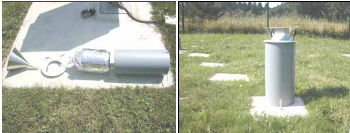
Photo 1 : Vue détaillée des différents éléments constituant le collecteur Photo 2 : Collecteur installé sur site
