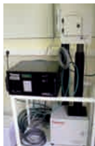
Analyseurs TEOM équipés d'un module FDMS.
