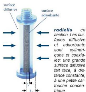
Photo 3 : symétrie du tube radiello (extrait du protocole de surveillance du formaldéhyde-LCSQA)
