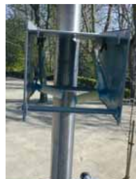
Photo 4 : tubes à diffusion passive installés dans leur boîte de protection
