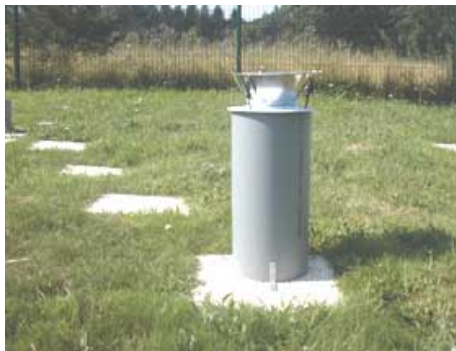
Collecteur de précipitations utilisé pour la mesure des dépôts de dioxines et furanes
