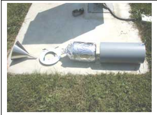
Photo 5 - Vue détaillée des différents éléments constituant le collecteur
