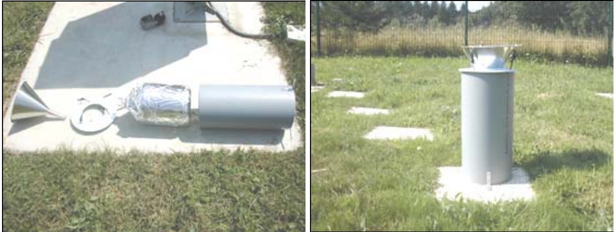
Photo 1 : Vue détaillée des différents éléments constituant le collecteur Photo 2 : Collecteur installé sur site
