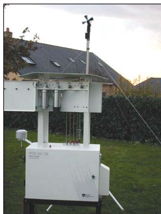
Photo 4 : Vue d'un système de prélèvement par filtre
