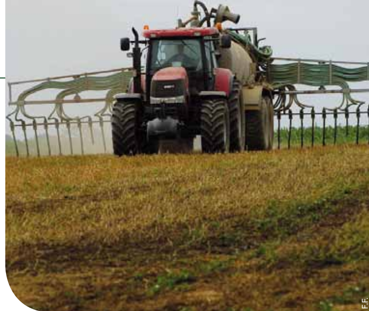
En fonction du type d'effluent, liquide ou solide, les techniques d'épandage sont plus ou moins émettrices d'ammoniac. Une modification du temps de pâturage des animaux joue sur leur durée de présence dans les bâtiments où les émissions par animal sont plus fortes.
