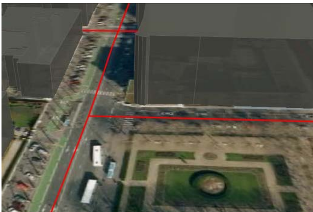
Figure 1 : Représentation graphique des caractéristiques d'une rue canyon ( H= 20 m, W= 34 m, H/W = 1.7 , Porosité Droite = 0.08, Porosité Gauche = 0.32)
