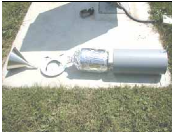
Photo 1 : Vue détaillée des différents éléments constituant le collecteur Photo 2 : Collecteur installé sur site
