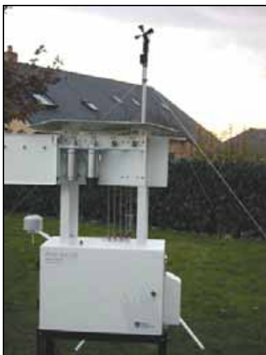
Photo 4 : vue du préleveur de chlorures particuliers et gazeux
