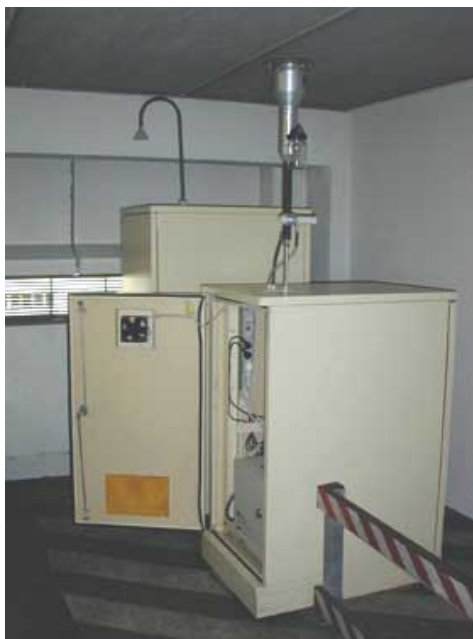
Station de mesure d’Air Pays de La Loire composée de deux armoires abritant les analyseurs automatiques
