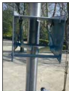
Photo 4 : tubes à diffusion passive installés dans leur boîte de protection
