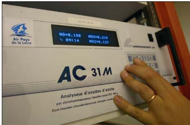
Photo 1: analyseur d'oxydes d'azote
