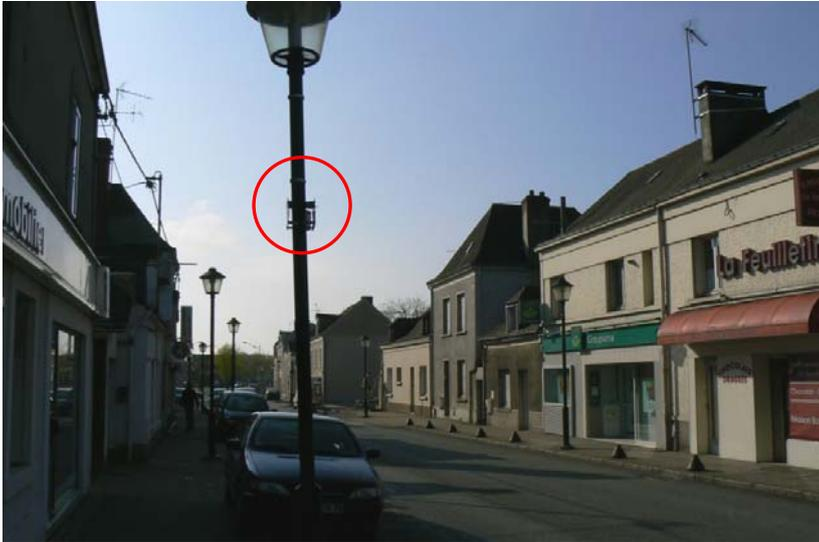
Photo 6 : Tubes à diffusion passive mesurant le benzène et le NO<sub>2</sub> au 56 avenue Mendès France
