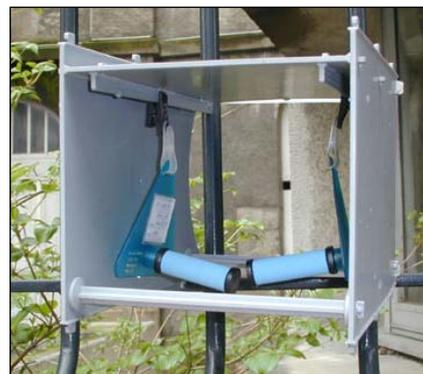
Photo 2 : tubes à diffusion passive Radiello mesurant le benzène installés dans leur boîte de protection
