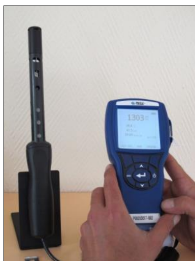
Photos 5 et 6 : appareil de mesure du dioxyde de carbone, de l'humidité relative et de la température dans les locaux d'enseignement
