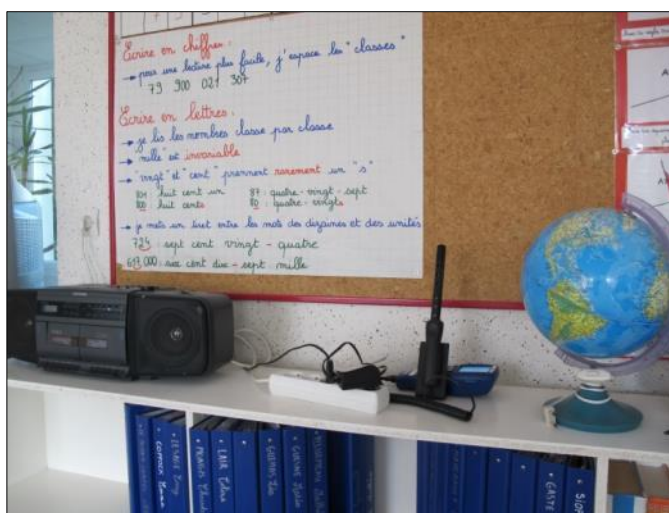
Photos 5 et 6 : appareil de mesure du dioxyde de carbone, de l'humidité relative et de la température dans les locaux d'enseignement
