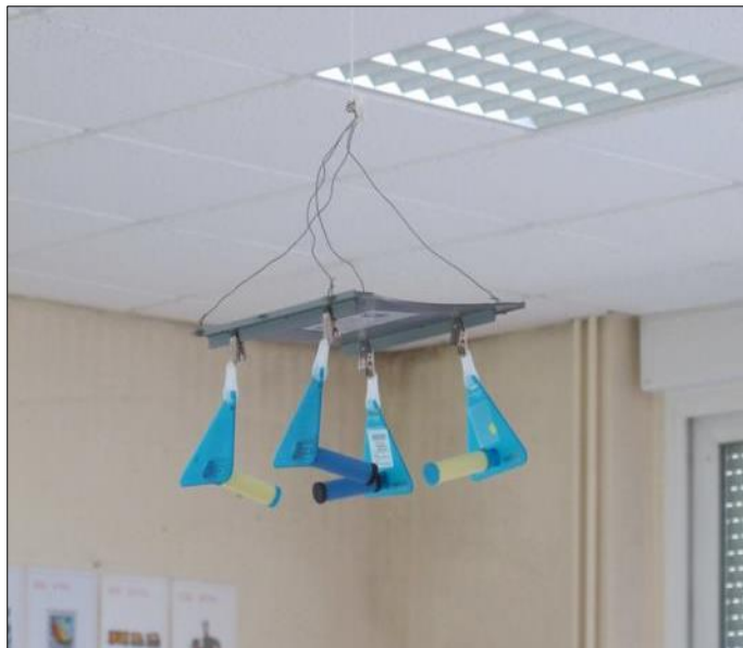
Photos 3 et 4 : dispositif de mesure du formaldéhyde et du benzène dans les locaux d'enseignement
