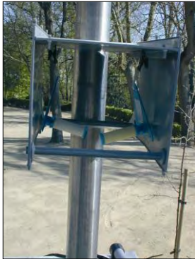
Figure 3 : tubes à diffusion passive installés dans leur boîte de protection
