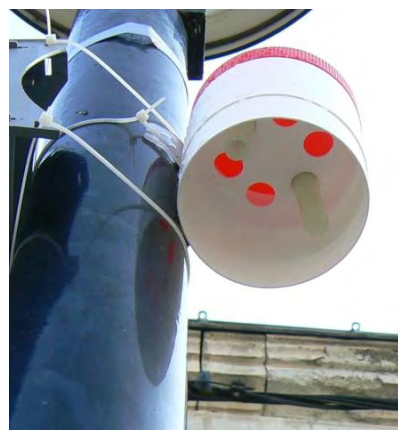
Photo 3 : tubes Passam dans sa boîte de protection
