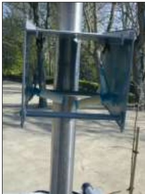
Photo 5 : tubes à diffusion passive dans leur boîte de protection
