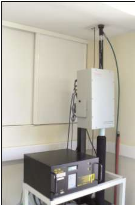
Photo 3 : un analyseur de particules TEOM équipé d'un module additionnel FDMS
