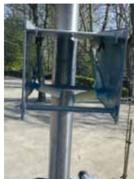
Photo 3 : tubes à diffusion passive installés dans leur boîte de protection
