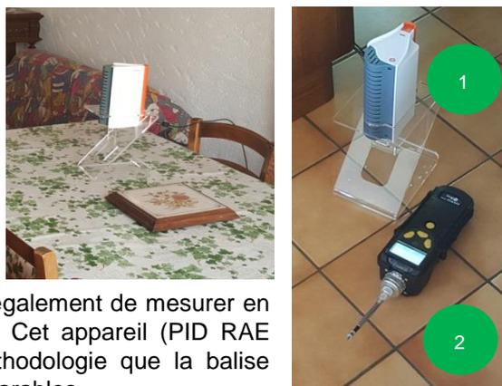
Figure 1 : Balise Azimut (1) et PID (2)
