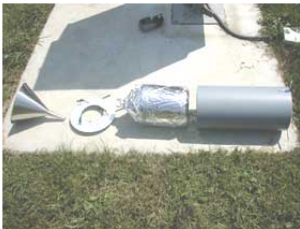
Photo 1 : Vue détaillée des différents éléments constituant le collecteur
