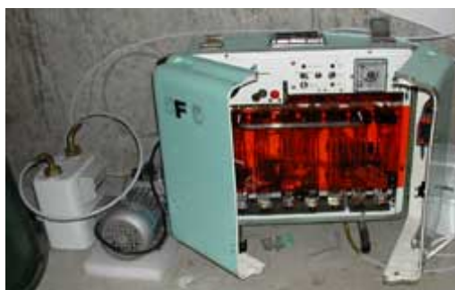
Photo 5 : Vue du dispositif séquentiel de prélèvement par barboteurs
