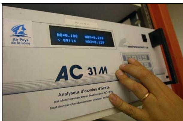
photo 2 : Analyseur d'oxydes d'azote
