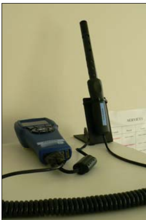
Photo 1 : appareil Q-Track mesurant le dioxyde de carbone, la température et l'humidité
