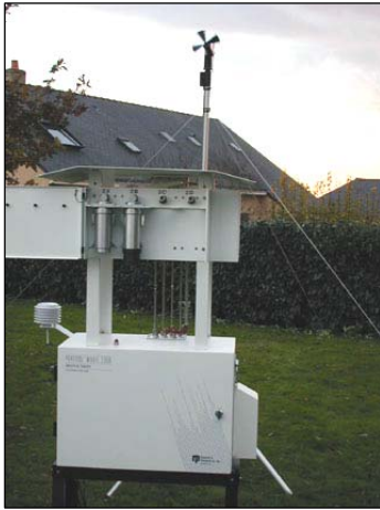
Photo 4 : vue d'un système de prélèvement par filtre
