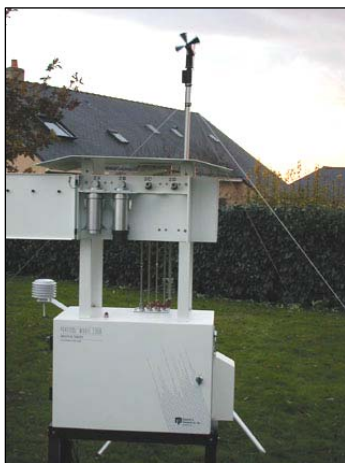
Photo 4 : vue d'un système de prélèvement par filtre
