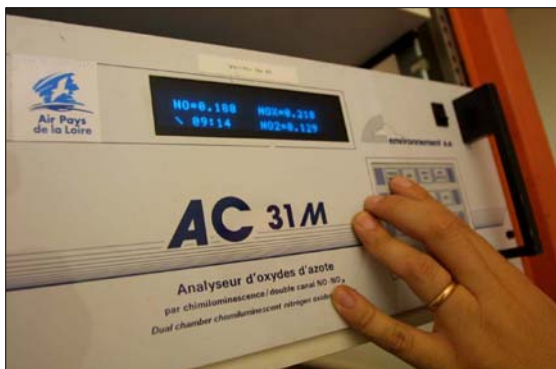
Photo 5 : analyseur automatique d'oxydes d'azote
