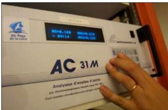
Photo 5 : analyseur automatique d'oxydes d'azote
