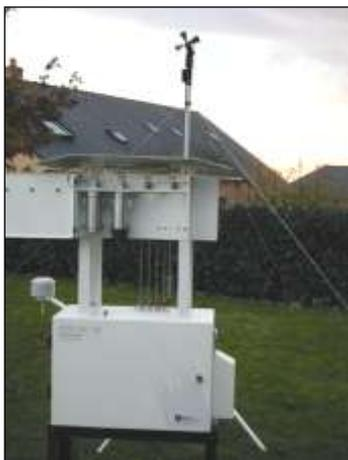
Photo 4 : vue d'un système de prélèvement par filtre
