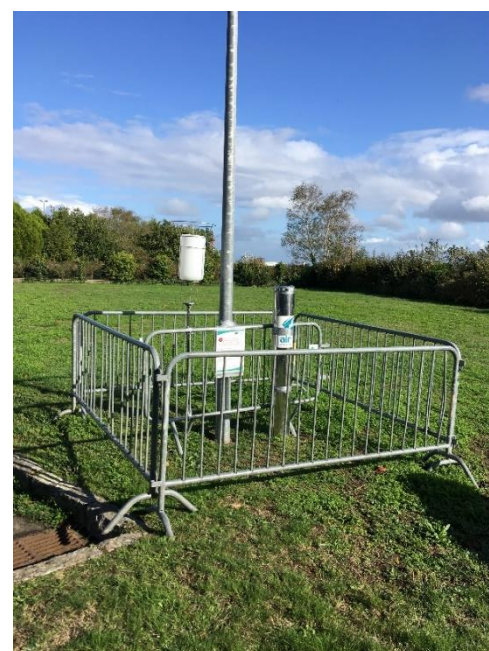
Jauges de récupération des eaux de pluie de Couëron
