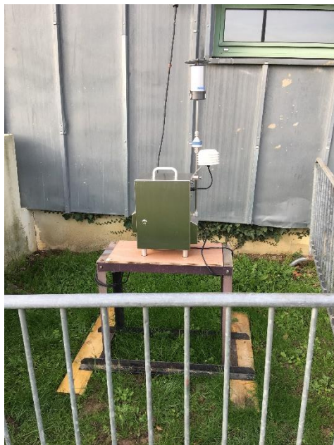
Vue du préleveur d'acide chlorhydrique gazeux
