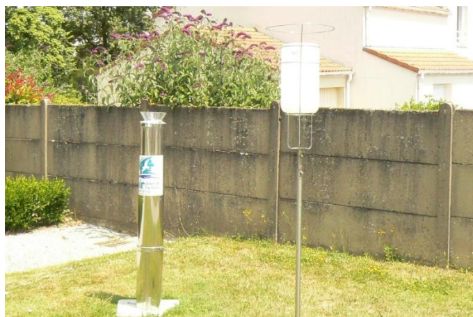
Jauges de récupération des eaux de pluie de Saint-Jean-de-Boiseau (à gauche pour l'analyse des dioxines et les furanes, à droite pour les métaux)
