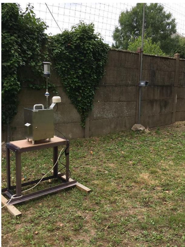
*Collecteur atmosphérique pour les prélèvements de métaux lourds et d'acide chlorhydrique à gauche et à droite la boîte de protection pour les prélèvements d'acide fluorhydrique par tubes à diffusion passive*
