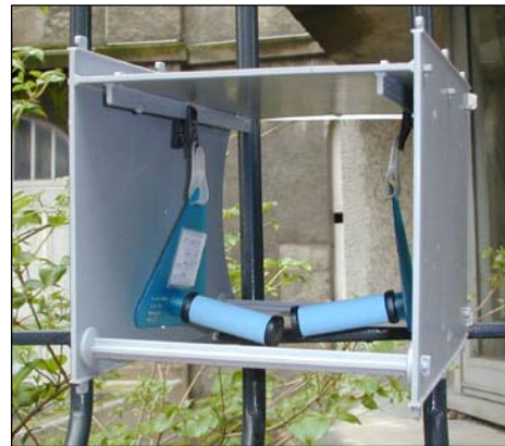
Photo 3 : tubes à diffusion passive installés dans leur boîte de protection
