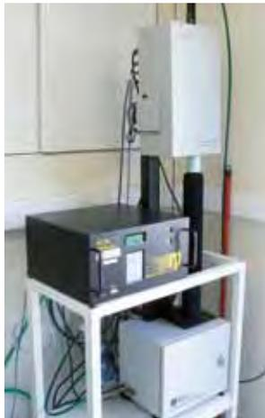
Analyseur équipé d'un module FDMS
