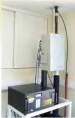
Analyseur TEOM équipé d'un module FDMS
