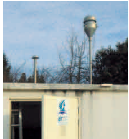
Préleveur des hydrocarbures aromatiques polycycliques à Cholet
