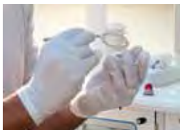
Changement du filtre quartz d'un préleveur de métaux lourds sur le site de l'Usine des eaux
