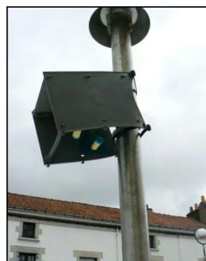
Photo 3: dispositif de mesure du benzène par tubes à diffusion passive fixé sur le laboratoire mobile
