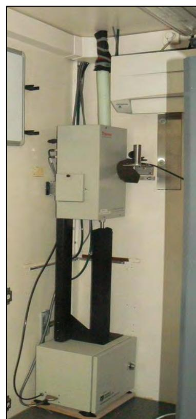
*Photos 1 et 2 : analyseurs de NO<sub>2</sub>, CO (photo à gauche) et analyseur TEOM équipé d’un module additionnel FDMS mesurant les particules PM10 (photo à droite) installés dans le camion laboratoire*
