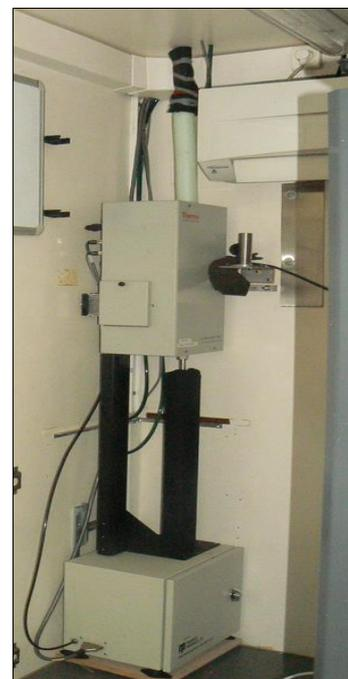
Figure 2 : analyseur TEOM équipé d'un module additionnel FDMS mesurant les particules PM<sub>10</sub>
