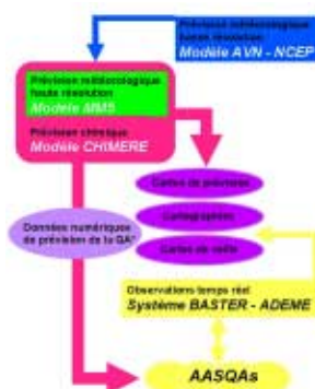
Figure 2 : Principe de fonctionnement du système PREV'AIR avec le module chimique CHIMERE (résolution de 0,5 °)
