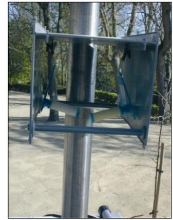
Figure 6 : tubes à diffusion passive installés dans leur boîte de protection
