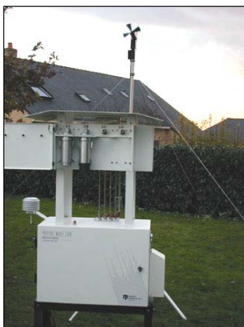
Photo 4 : vue d'un système de prélèvement par filtre
