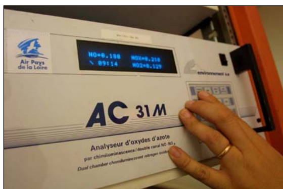
Photo 5 : analyseur automatique d'oxydes d'azote
