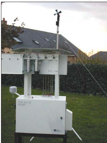
Photo 3 : vue du préleveur de chlorures particuliers et gazeux
