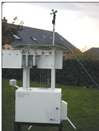
Photo 4 : vue d'un système de prélèvement par filtre
