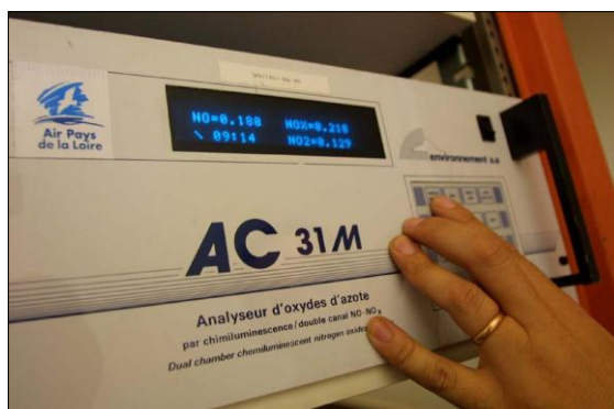
Photo 5 : analyseur automatique d'oxydes d'azote
