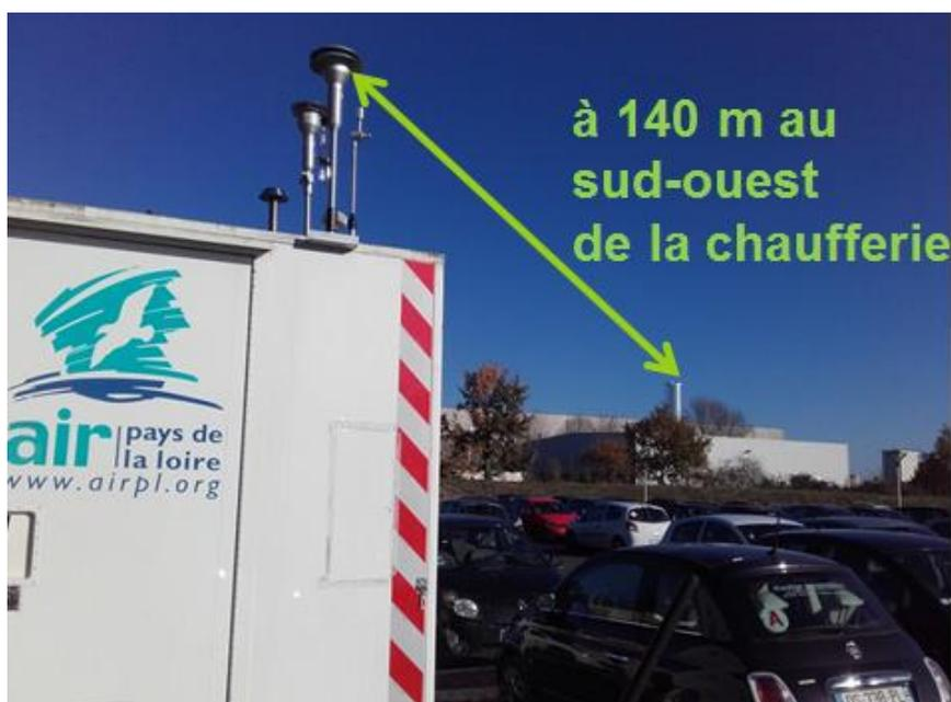
Photo 2 : laboratoire mobile et chaufferie Belle-Beille
