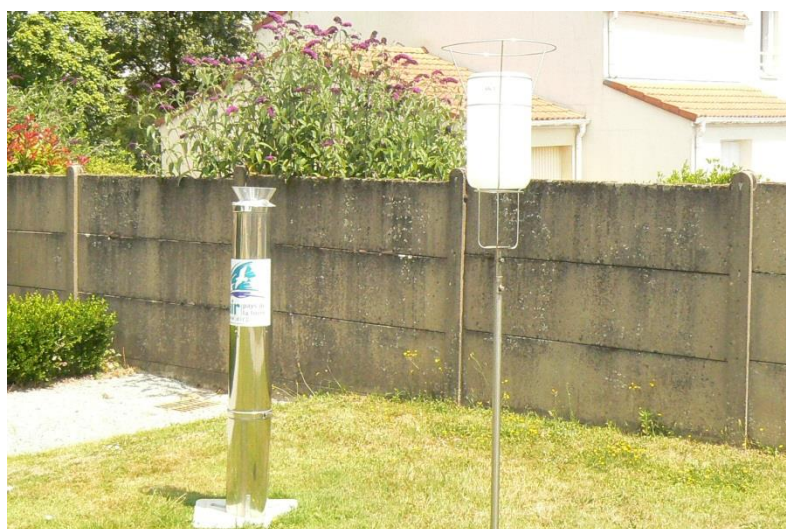
Photo 3 : jauges de récupération des eaux de pluie (à gauche pour l'analyse des dioxines et les furanes, à droite pour les métaux)
