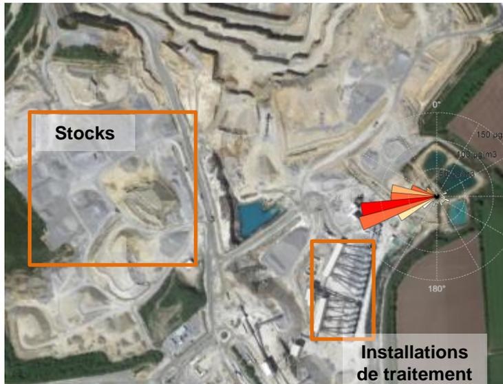
Figure 23 : rose de pollution des  $PM_{10}$  au niveau du site mobile installé dans la carrière
