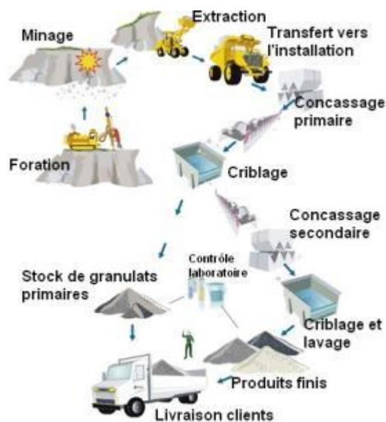
Figure 1 : schéma de principe de fonctionnement d'une carrière de roche massive [6]
