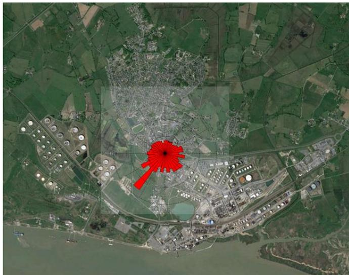
Figure 12 : rose de pollution des niveaux moyens en COVNM mesurés rue Pasteur, à Donges du 15 février au 14 mars 2017. Le cercle extérieur de la rose est à  $240 \mu\text{g}/\text{m}^3$
