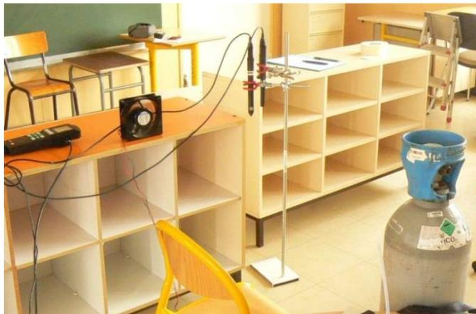
Photo 10 : mesure du taux de renouvellement de l'air après injection de CO<sub>2</sub>
