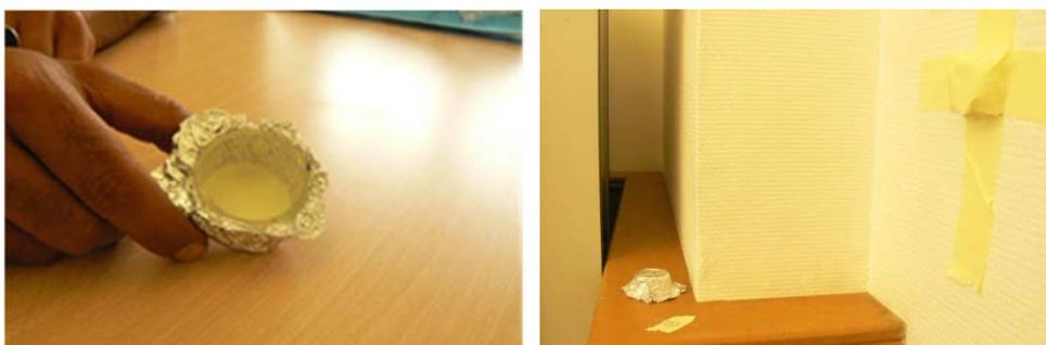
*Echantillonneurs passifs posés sur du mobilier et fixés au mur dans un établissement*
