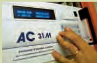
Analyseur d'oxydes d'azote
