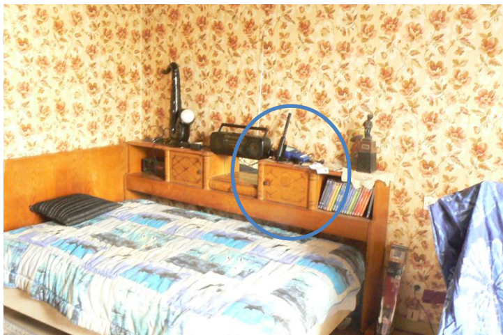
Photo 3 : appareil de mesure du dioxyde de carbone, de l'humidité relative et de la température dans la chambre
