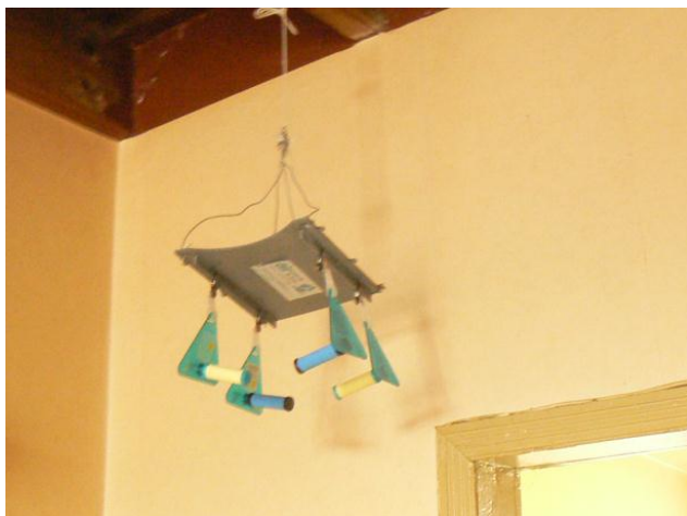
Photo 2 : dispositif de mesure du formaldéhyde et du benzène dans la pièce de vie
