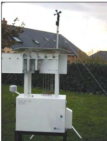
Vue d'un système de prélèvement par filtre
