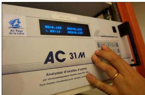
Analyseur automatique d'oxydes d'azote
