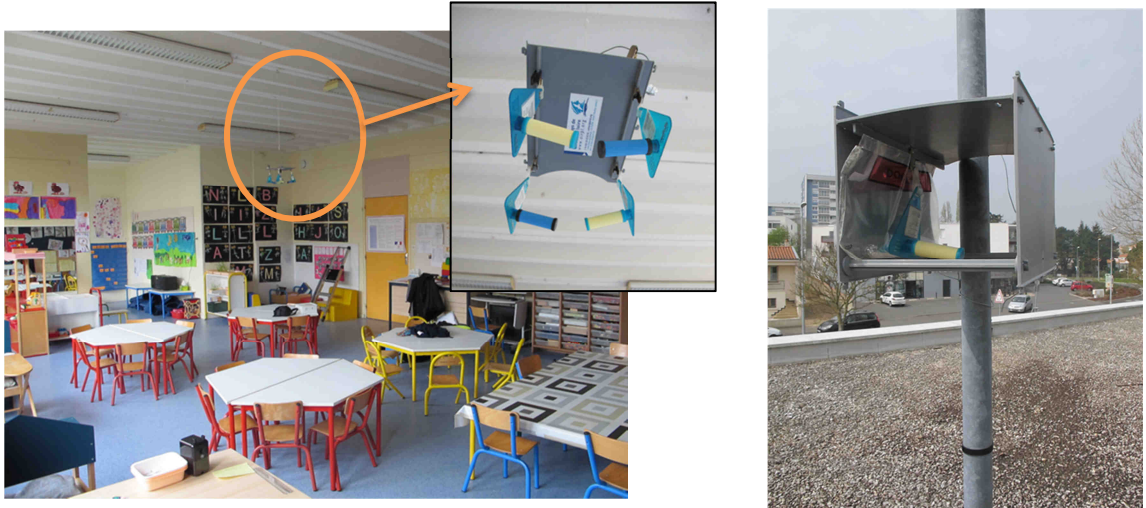
photos 1 : dispositif de mesure du formaldéhyde et du benzène
