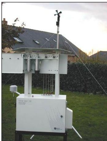
Vue d'un système de prélèvement par filtre
