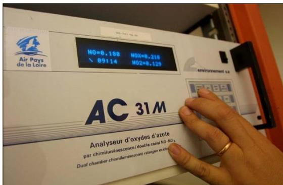
*Analyseur automatique d'oxydes d'azote*
